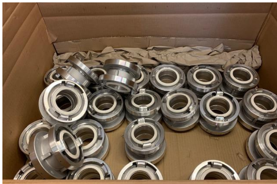
Verbindungsstücke für NL und D Feuerwehrschläuche (© Naturpark MSN)
